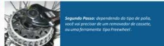
**Segundo Passo:** dependendo do tipo de polia, você vai precisar de um removedor de cassete, ou uma ferramenta tipo Freewheel.
